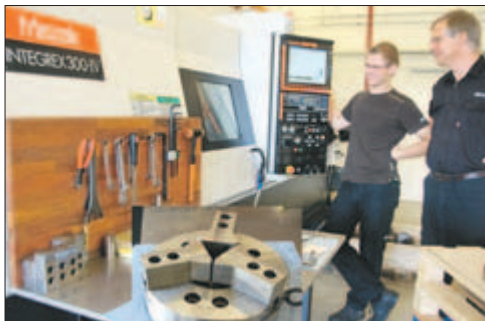
Hans Henrik Krogsgaard Madsen (t.h.) og sønnen Kristian, der er fjerde års lærling i maskinfabrikken, er glade for den seneste investering i denne Integrex 300-IV. Indsat ses en spændepatron med bløde bakker, som med en stor kontaktflade sikrer korrekt opspænding af emner fra diameter 60 til 80 millimeter.
